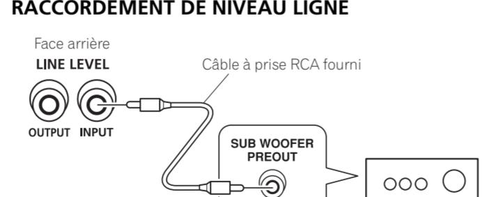
Cette connexion est destinée à un amplificateur ou un récepteur muni d'une borne SUBWOOFER PREOUT. Relier cette borne à la borne LINE LEVEL INPUT du subwoofer à l'aide du câble à prise RCA fourni.
